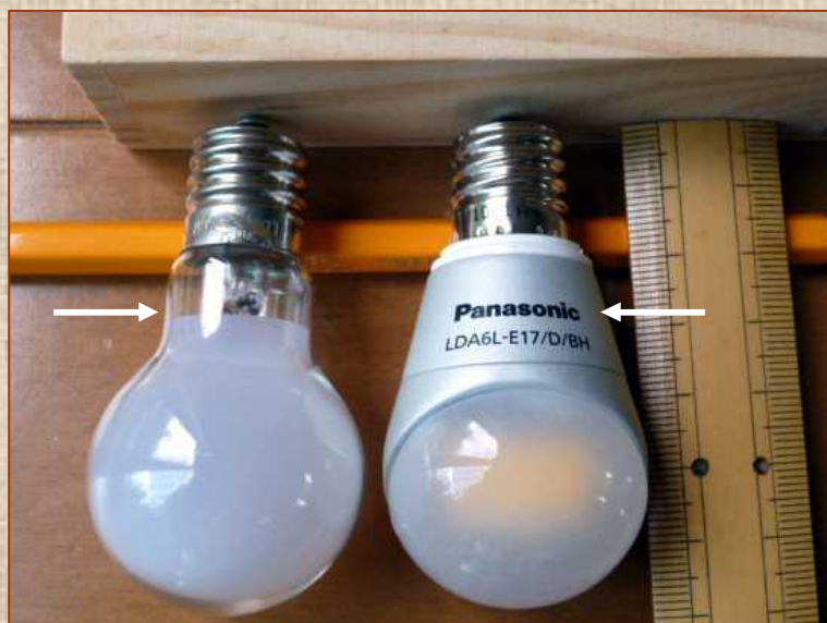
原因は、首部がソケットに突っかけて電極に届いていない。(電極爪を起したりしてもダメだった。)
